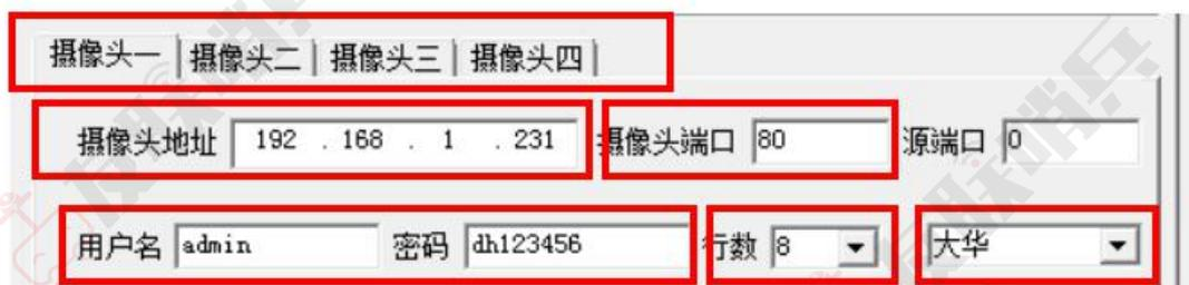
3.下方为 8 行的叠加信息（若为单通道摄像头，只需要填写第一行的信息即可），默认内容填写后为摄像头固定显示的内容，当收到 485 设备上传的内容后，此内容不再显示。例如：摄像头编号 1 的区域 1 默认内容填写“aaa”，若字符叠加器的 RS485 接收端没有接收到 485 设备发送的内容，摄像头区域一位置会一直显示“aaa”，若字符叠加器 RS485 端接收到 485 设备发送的内容为“温度：18℃”，摄像头 1 区域一显示“温度：18℃”，“aaa”将不再显示。（注意：大华的摄像头第一行为固定显示只能填写数字或字母，汉字无效，如需叠加固定信息或 485 上传内容，需从通道二开始叠加）
