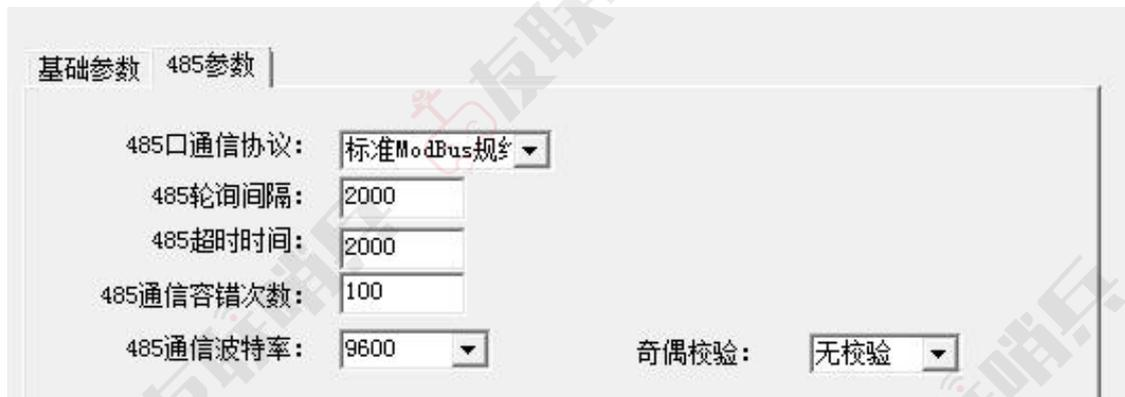
**485 口通讯协议：**字符叠加器有两种通信协议可选择，若用户使用产品为仁科定制扬尘设备选择内部规约，其他产品选择标准 Modbus 规约。
